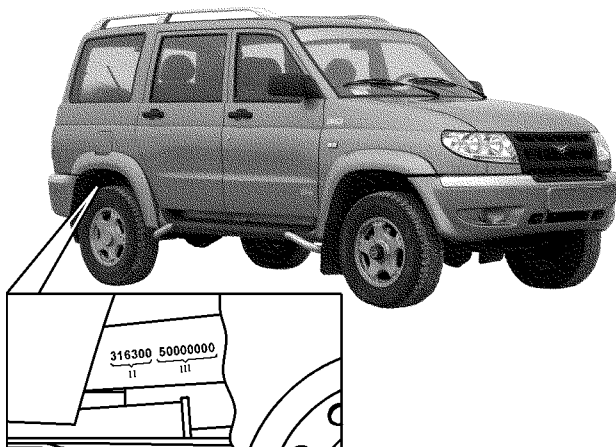
Рис. 1.3. Расположение идентификационного номера шасси
