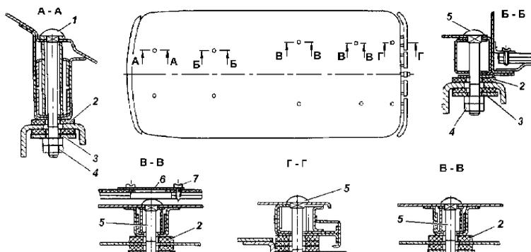
Рис. 10.1. Крепление кузова к раме:
