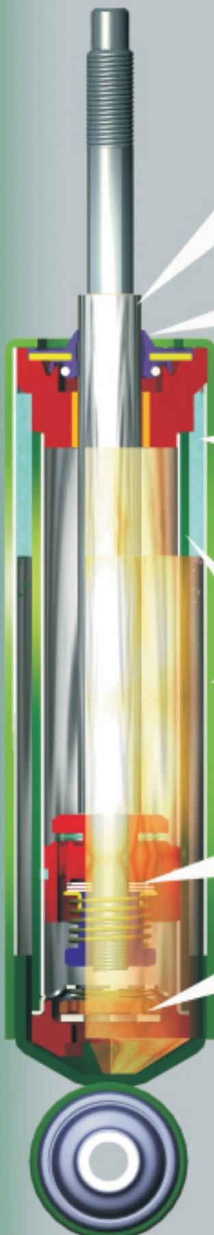
**Шток из высококачественной стали с индукционной термической обработкой и износостойким катодно-механическим хромовым покрытием.**
