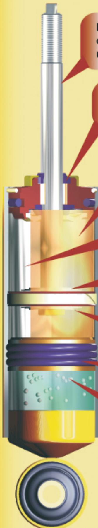
Шток из высококачественной стали с индукционной термической обработкой и износостойким хромовым покрытием
